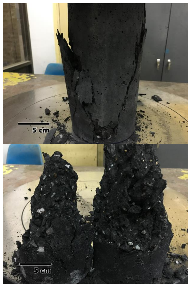
รูปที่ 4 ตัวอย่างจีโอโพลิเมอร์คอนกรีตหลังจากการทดสอบกำลังรับแรงอัดด้วยเครื่องทดสอบแรงกดแรงดึง
