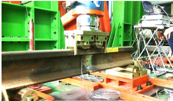
รูปที่ 3 แบบจำลองการทดสอบการดัด 4 จุด ของรางรถไฟ 60E1 ที่ผ่าน การเชื่อมชนวาบ
