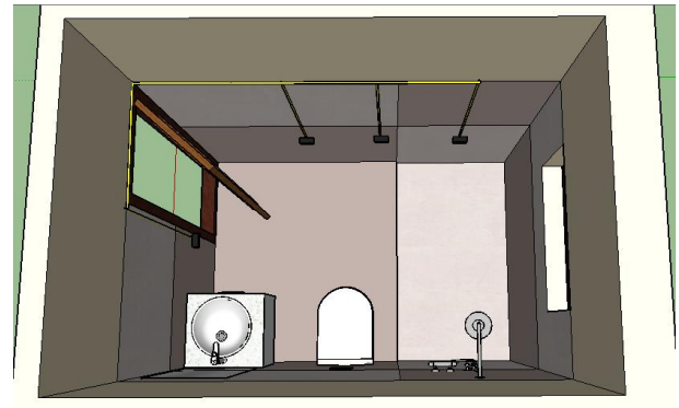
รูปที่ 8 ภาพมุมมองบนของการติดตั้งอุปกรณ์ตรวจวัดภายในห้องน้ำ
