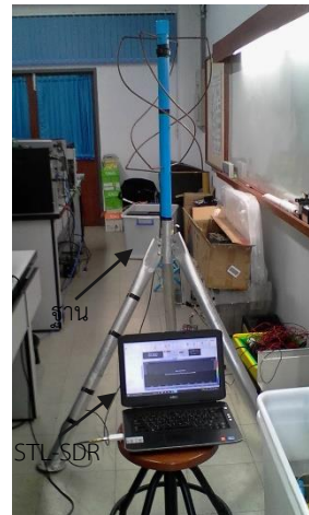
รูปที่ 28 ภาพโดยรวมของสถานีภาคพื้นดินอย่างง่ายที่สร้างขึ้นจากสายอากาศแบบที่เหมาะสมที่สุด
