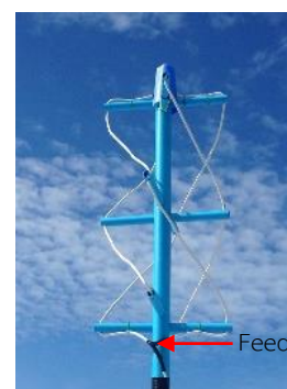
รูปที่ 10 สายอากาศแบบ QFH แบบที่ 1 ขณะรับสัญญาณ
