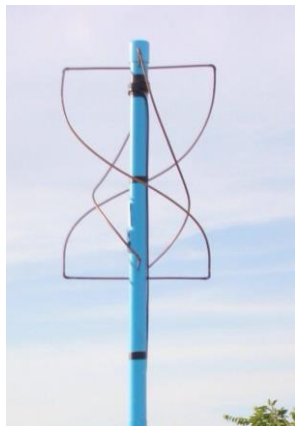
รูปที่ 16 สายอากาศแบบ QFH แบบที่ 2 ขณะรับสัญญาณ
