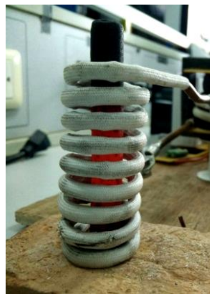
รูปที่ 7 ตัวอย่างชิ้นงานขนาด 12 มิลลิเมตร หัวที่ 1 ขณะได้รับความร้อนเหนี่ยวนำที่อุณหภูมิ 300 องศาเซลเซียส
