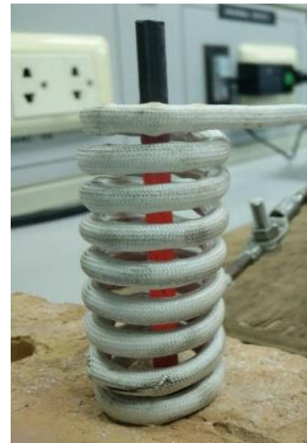
รูปที่ 11 ตัวอย่างชิ้นงานขนาด 6 มิลลิเมตร หัวที่ 1 ขณะได้รับความร้อนเหนี่ยวนำที่อุณหภูมิ 300 องศาเซลเซียส
