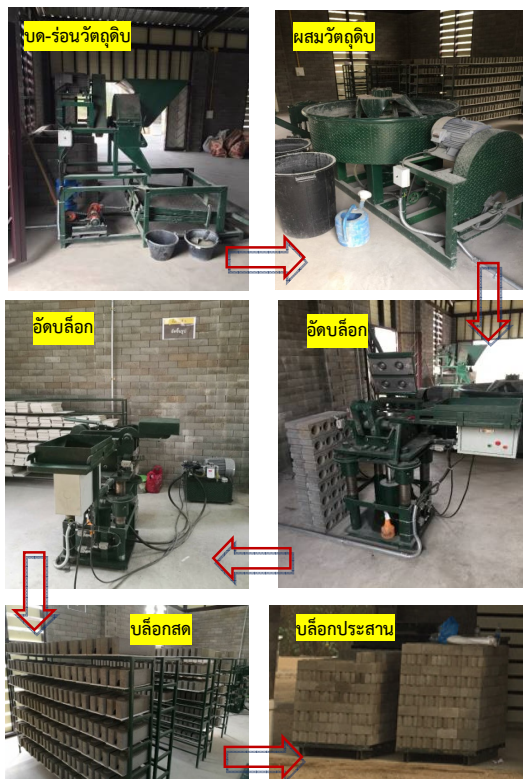
รูปที่ 4 กระบวนการผลิตบล็อกประสานโดยใช้เครื่องจักรและอุปกรณ์
