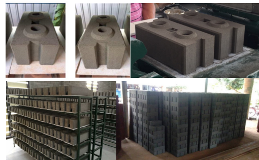
รูปที่ 3 บล็อกประสานที่ผลิตจากเถ้าหนักโรงไฟฟ้าแม่เมาะ
