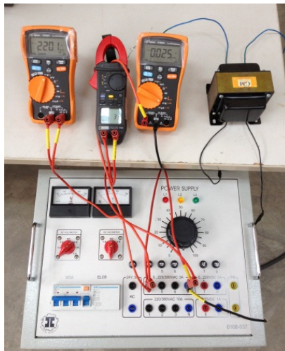
(ข) การทดสอบหม้อแปลงไฟฟ้าในห้องปฏิบัติการ
