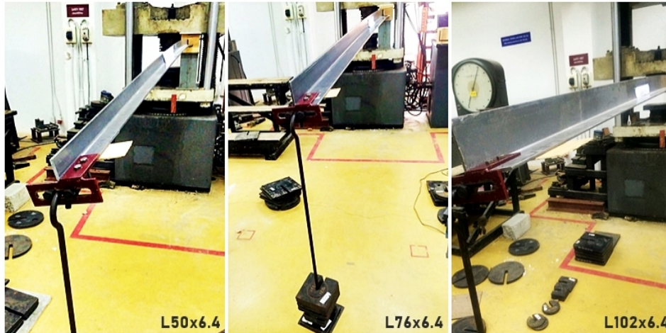
รูปที่ 4 ลักษณะการวิบัติของคาน FRP หน้าตัดฉากที่มีจุดรองรับแบบคานยื่น
