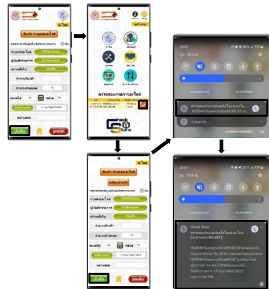
รูปที่ 19 แสดงการแจ้งเตือนเมื่อปริมาณอะไหล่คงคลังเหลือน้อยกว่าหรือเท่ากับ 50 ตัว
