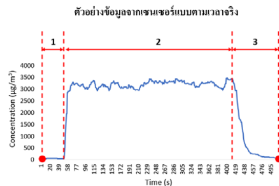
รูปที่ 6 ตัวอย่างข้อมูลที่ได้ออกจากเซนเซอร์แบบตามเวลาจริง โดยจุดวงกลมแสดงถึงจุดที่เริ่มต้นและสิ้นสุดการเก็บข้อมูล
