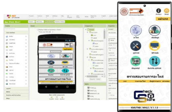
รูปที่ 15 เว็บพัฒนาแอปพลิเคชัน (ซ้าย) และภาพแสดงแอปพลิเคชันบนโทรศัพท์มือถือ (ขวา)
