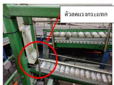
รูปที่ 7 ตัวลดแรงกระแทกชำรุดเสียหาย
