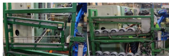
รูปที่ 13 รางลำเลียงคูลเลอร์จักรยานยนต์ (ก) ก่อนการ ปรับปรุง (ข) หลังปรับปรุง
