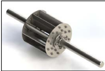
รูปที่ 2 แบบจำลองเครื่องกลเดิมอากาศในน้ำ [5]
