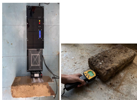
รูปที่ 7 การทดสอบค่าความชื้นของอิฐดินด้วยเครื่องต้นแบบและเครื่องวัดความชื้นทั่วไป
