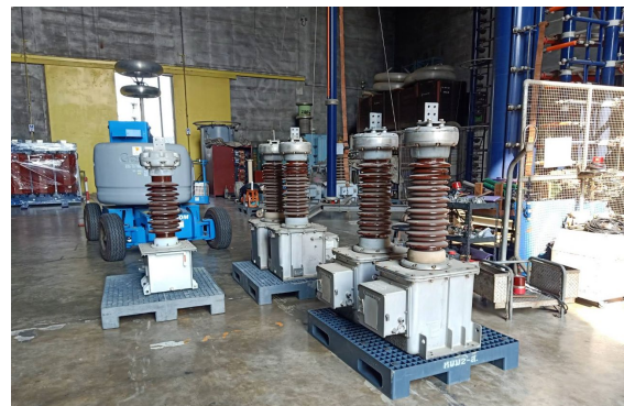
รูปที่ 11 หม้อแปลงวัดแรงดันแบบตัวเก็บประจุสำหรับต่อขนานเพิ่มเพื่อชดเชยค่าความจุไฟฟ้า
