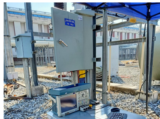
รูปที่ 4 การวัดขนาดและรูปคลื่นของแรงดันที่บัส 22 kV โดยใช้ฮอสซิลโลสโคปเชื่อมต่อกับขดลวดแรงต่ำของหม้อแปลงวัดแรงดัน
