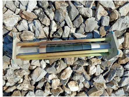
รูปที่ 3 กับดักเสิร์จที่เกิดความเสียหายจากความร้อน
