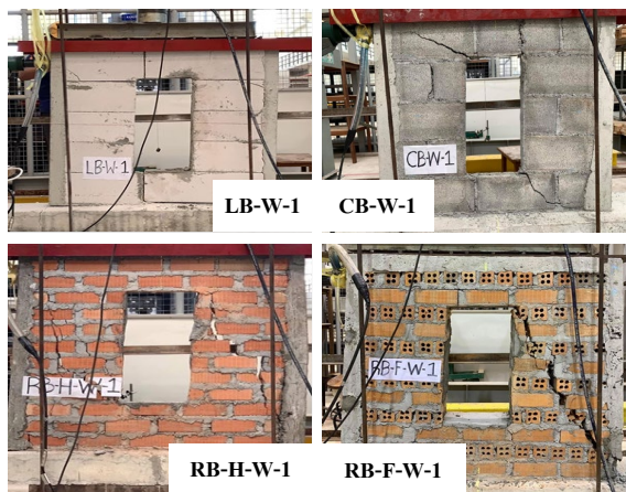
รูปที่ 18 การวิบัติของผนังก่ออิฐรูปแบบที่ 3
