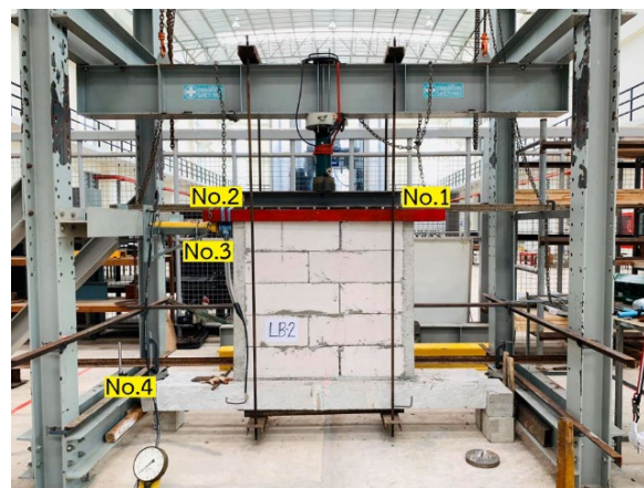
รูปที่ 6 การติดตั้งผนังอิฐและชุดทดสอบในห้องปฏิบัติการ
