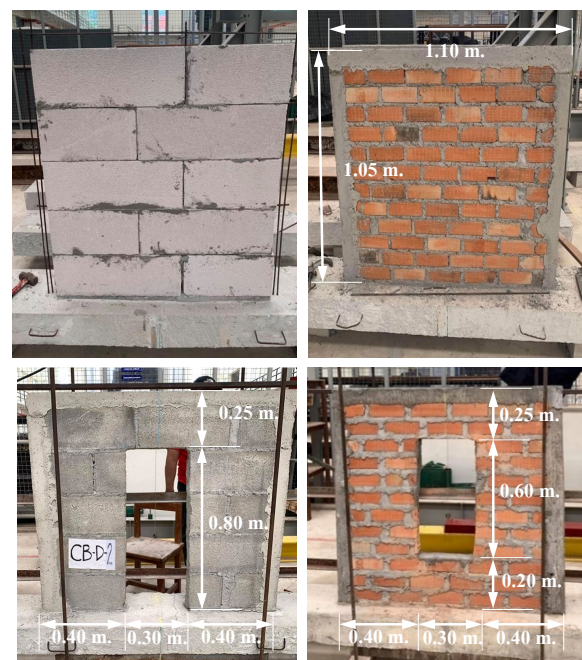
รูปที่ 3 ผนังก่ออิฐที่ใช้ในการศึกษา (ระบุตำแหน่งช่องเปิด)
