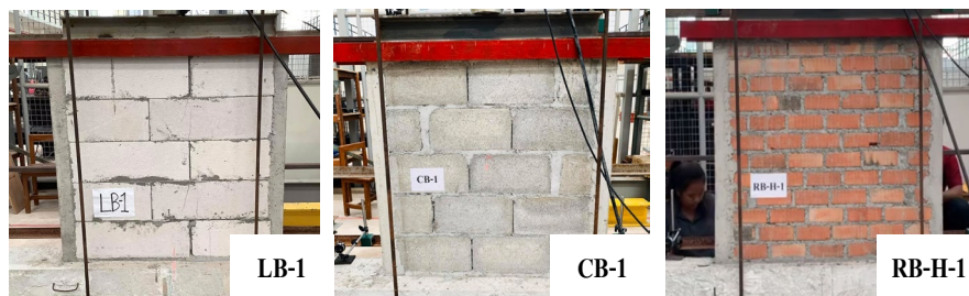
รูปที่ 16 การวิบัติของผนังก่ออิฐรูปแบบที่ 1
