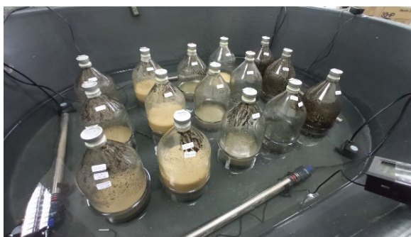
รูปที่ 3 ชุดการทดลองศึกษาศักยภาพการผลิตก๊าซมีเทนของน้ำเสียจากการล้างหนอนแมลงวันลาย
