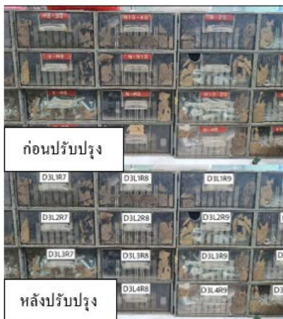
รูปที่ 11 ตัวอย่างการกำหนดรหัสตำแหน่งที่จัดเก็บก่อนและหลังการปรับปรุง
