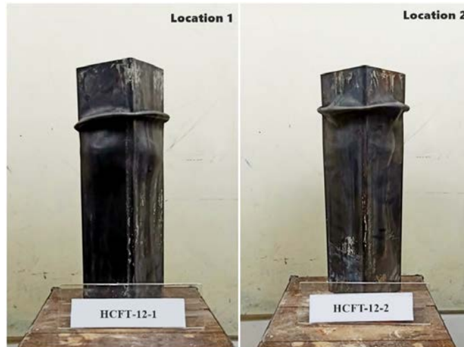
รูปที่ 5 ลักษณะการวิบัติของเสา HCFT
