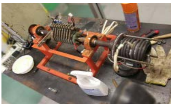
รูปที่ 1 เครื่องทดสอบการไหลแบบหมุนแกนเดียว (The Axial Powder Flow Apparatus)
