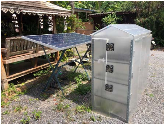
รูปที่ 8 การทดสอบระบบควบคุมสภาพแวดล้อมภายในโรงเรือน
