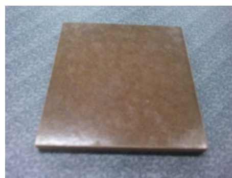
รูปที่ 1 ชิ้นงานตัวอย่างในการทดสอบความขรุขระผิว
