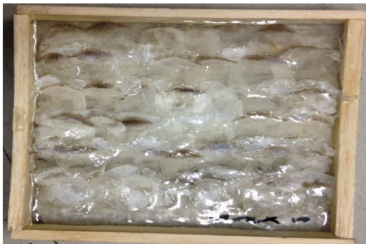
รูปที่ 4: โพลีเอสเตอร์เรซินชนิดไม่แข็งตัวผสมกับตัวเร่งให้แข็งตัวให้มีความหนา 10 mm. และทิ้งไว้เป็นเวลา 2 ชั่วโมง
