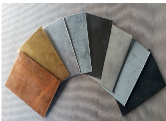
รูปที่ 6 แผ่นโลหะ 8 ชนิดที่นำมาใช้ในการทดสอบได้แก่ ทองแดง ทองเหลือง อะลูมิเนียม เหล็กชุบกัลวาไนส์ อะลูมิเนียมขัดเงา สเตนเลส เหล็กชิทไฟล์และเหล็ก
