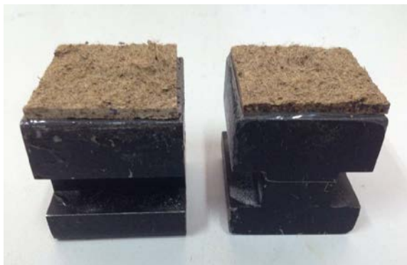
รูปที่ 3 ลักษณะการวิบัติของแผ่นใยไม้อัดที่เสริมแรงด้วยเส้นใยผลตาลโดนดหลังจากทดสอบการดึงตั้งฉากกับผิวหน้า
