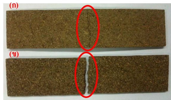
รูปที่ 6 ลักษณะการวิบัติของแผ่นใยไม้อัด (ก) ที่เสริมแรงด้วยเส้นใยผลตาลโดนด และ (ข) ที่ไม่เสริมแรงด้วยเส้นใยผลตาลโดนด หลังจากทดสอบการดัด
