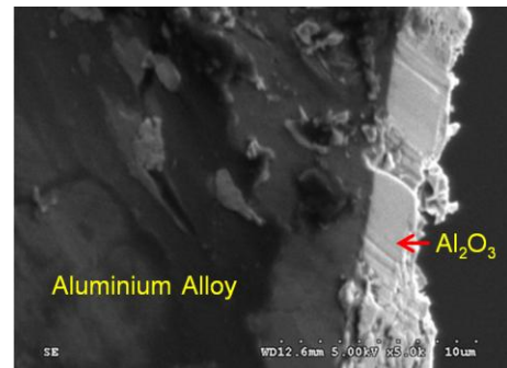
รูปที่ 2 ลักษณะของผิวอะลูมิเนียมออกไซด์บนชิ้นงาน
