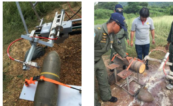
รูปที่ 12 การตัดลูกระเบิด Air Bomb 100 ปอนด์
