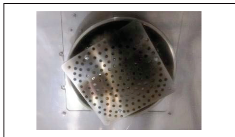
ภาพที่ 24 ตะแกรงกั้นความร้อน
