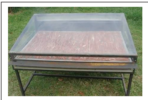
ภาพที่ 6 เครื่องอบปลาแดดเดียวด้วยแสงอาทิตย์แบบมีที่ครอบกันฝนและแมลงวัน
