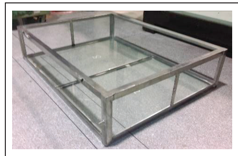
ภาพที่ 19 ส่วนตู้อบของเครื่องอบปลาแดดเดียว
