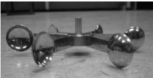
ภาพที่ 9 ชุดงานใบพัดสแตนเลสที่พร้อมนำไปเสียบต่อเชื่อมกับแกนไดนาโม
