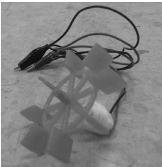
ภาพที่ 10 ชุดงานใบพัดพลาสติกเชื่อมติดกับไดนาโม
