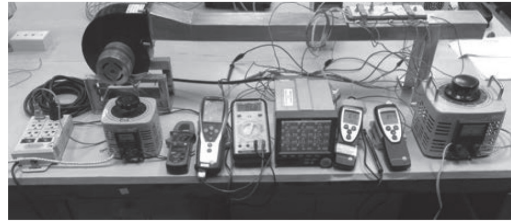
ภาพที่ 5 การทดลองระบบแลกเปลี่ยนความร้อนด้วยอากาศที่อุณหภูมิ 170 220 และ 270°C
