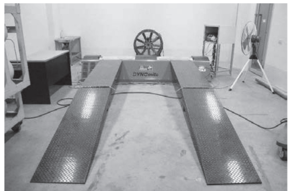
ภาพที่ 4 แท่นทดสอบสมรรถนะรถยนต์ชนิด Chassis Dynamometer
