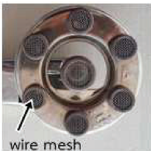
ภาพที่ 2 ลักษณะหัวเตาแบบ Vertical port
