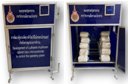
ภาพที่ 3 โครงสร้างจริงของตู้ปลูก เห็ดนางฟ้าแบบอัตโนมัติ
