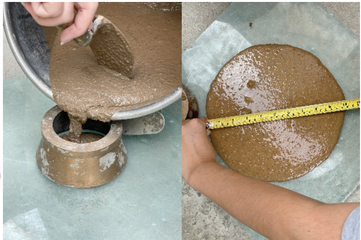
ภาพที่ 5 โคลนมาตรฐานสำหรับทดสอบการไหลแผ่
