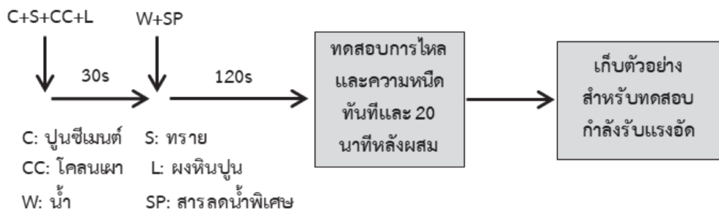
ภาพที่ 7 ลำดับขั้นตอนการผสมและการทดสอบ
