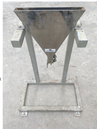
ภาพที่ 6 กรวยมาตรฐานสำหรับทดสอบความหนืดของมอร์ตาร์
