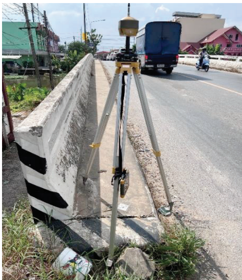
ภาพที่ 3 ตำแหน่งหมุด GNSS 610373 เป็นสถานีฐาน GNSS วิธี RTK และวิธี Post process Kinematic (PPK)
