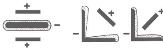
ภาพที่ 2 การเคลือบจากการจัดวางตำแหน่งระหว่างพื้นผิวชิ้นงานหรือขั้วลบ (Cathode) และขั้วไฟฟ้าช่วย (Counter electrode) หรือขั้วบวก (Anode) [6]
