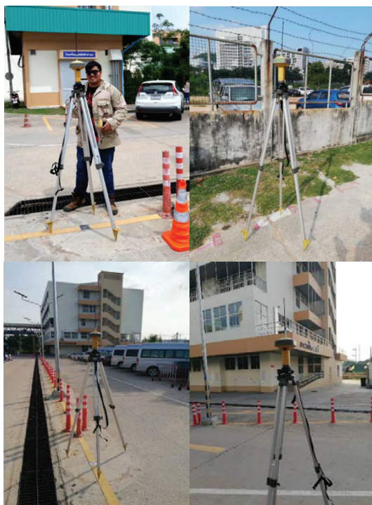
ภาพที่ 1 การรังวัดค่าพิกัดด้วยระบบดาวเทียม GNSS ณ โรงพยาบาลแหลมฉบัง จ.ชลบุรี
