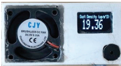
ภาพที่ 6 อุปกรณ์ตรวจวัดฝุ่นส่วนบุคคล สำหรับกิจกรรมก่อสร้าง
