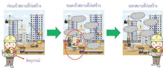
ภาพที่ 3 การทำงานของอุปกรณ์ตรวจวัดฝุ่นส่วนบุคคล
