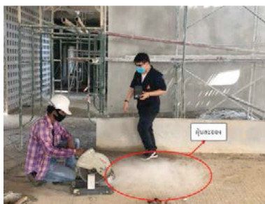
ภาพที่ 11 การทดสอบต้นแบบอุปกรณ์สำหรับงานตัดอิฐมวลเบา
