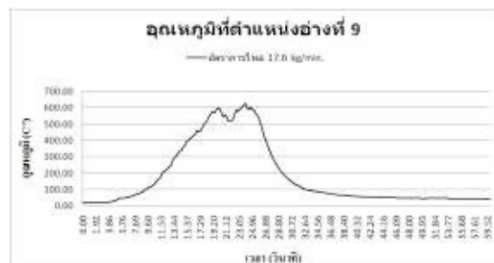
ภาพที่ 8 แสดงอุณหภูมิที่ระยะเวลาต่างๆ ของอัตราการไหล 17.6 kg/min
