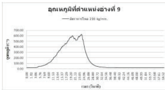
ภาพที่ 11 แสดงอุณหภูมิที่ระยะเวลาต่างๆ ของอัตราการไหล 216 kg/min
