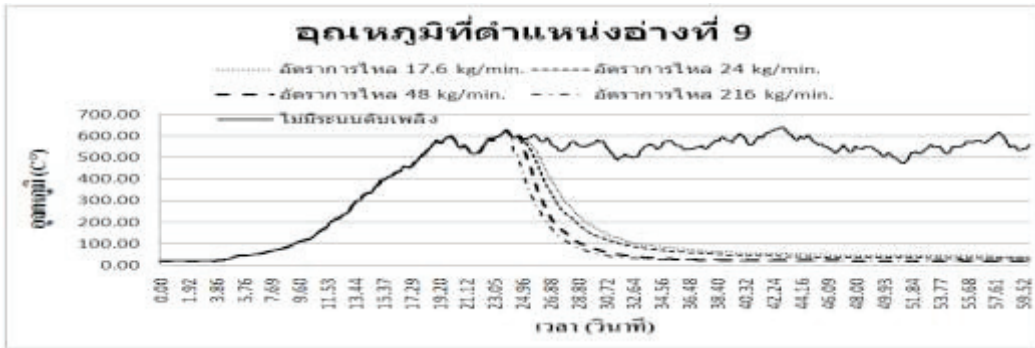
ภาพที่ 17 เปรียบเทียบอุณหภูมิที่เวลาต่างๆของอัตราการไหลทั้ง 5 กรณี
