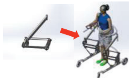
ภาพที่ 12 แสดงโมเดลที่ใช้ในการวิเคราะห์ กลไกพุงน้ำหนัก
