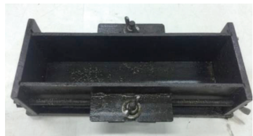
ภาพที่ 7 แบบขนาด 7 x 7 x 29 ซม.3 สำหรับหล่อตัวอย่างที่ใช้ในการทดสอบความต้านทานแรงดัด
