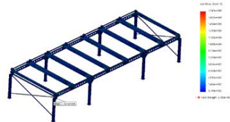
ภาพที่ 22 ผลการวิเคราะห์การกระจายของความเค้นในโครงสร้างที่จอดรถอัจฉริยะ
