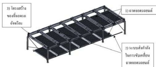
ภาพที่ 5 ชิ้นส่วนหลักของที่จอดรถอัจฉริยะแบบหน่วยแยก
