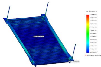
ภาพที่ 8 ผลการวิเคราะห์การกระจายของค่าความเค้นในถาดจอตรถยนต์
