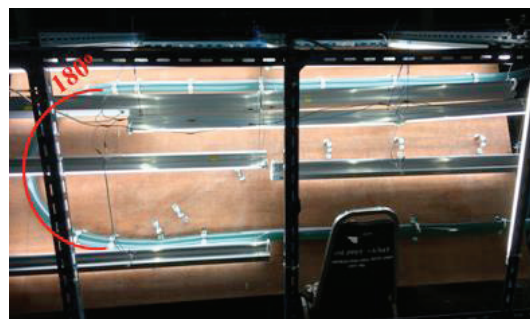
ภาพที่ 3 เครื่องปฏิกรณ์ชีวภาพแสงแบบท่อที่มีโค้งพื้นฐาน
