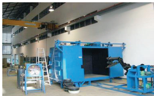
ภาพที่ 2 แสดงเครื่องขึ้นรูปแบบหมุนชนิด Shuttle-Style
