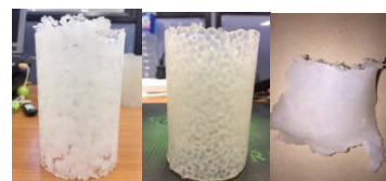
ภาพที่ 7 ชิ้นงานหลังการขึ้นรูปด้วยเครื่องทดสอบการไหลแบบหมุนแกนเดียวของ EVA/LLDPE Vistamaxx/LLDPE และ Nucrel/LLDPE ที่อัตราส่วน 50:50 (จากซ้ายไปขวาตามลำดับ)
