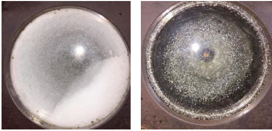
ภาพที่ 5 แสดงวัสดุในแม่พิมพ์ขณะที่ให้ความร้อนระหว่างขึ้นรูป (ซ้าย) อุณหภูมิ 70 °C และ (ขวา) 180 °C
