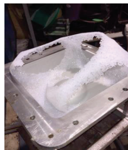
ภาพที่ 8 แสดงผลการขึ้นรูป EVA 100% ในแม่พิมพ์ของเล่นเด็ก
