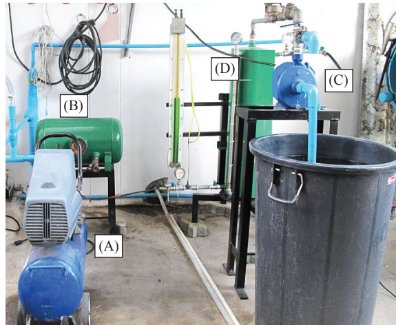
รูปที่ 1 แสดงรายละเอียดการต่ออุปกรณ์ในระบบ (A) ปั๊มลม (B) ถังพักก๊าซ (C) ป้ายน้ำ (D) ถัง Scrubber
