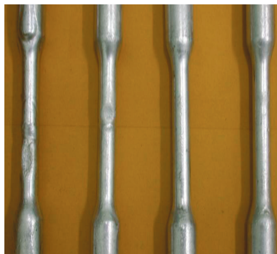
รูปที่ 11 ผลจากการเทน้ำโลหะลงแบบหล่อที่อุณหภูมิต่างกัน
