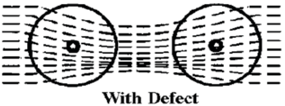
รูปที่ 2 การเปลี่ยนแปลงของฟลักซ์กรณีเกิดการลัดวงจรระหว่างรอบถึงรอบ [7]
