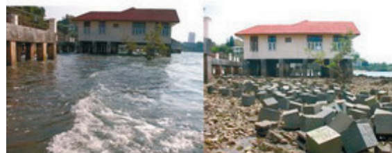
รูปที่ 1 จีโอพอลิเมอร์คอนกรีตจากเถาถ่านหินที่แช่ในน้ำทะเลในสภาพเปียกสลับแห้ง
