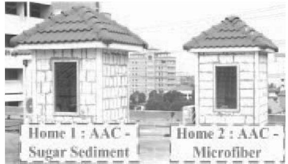
รูปที่ 1 บ้านจำลองทั้งสองหลังที่สร้างด้วย AAC-SS (ซ้าย) และ AAC - Microfiber (ขวา) [9], [10]
