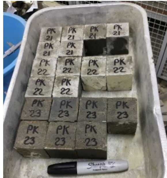
รูปที่ 1 ตัวอย่างมอร์ตาร์ปรับระดับการทดสอบ
