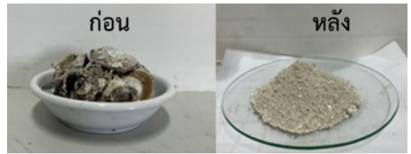
รูปที่ 1 เปลือกหอยนางรม (ก) ก่อน และ (ข) หลัง การเผาที่ 900 องศาเซลเซียส
