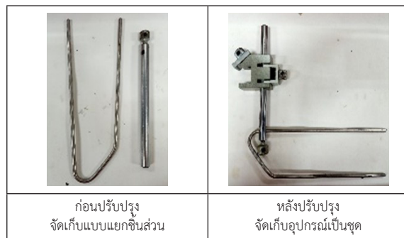
(ข) ภาพก่อนและหลังการปรับปรุงการจัดเก็บโค้ดกดทับชิ้นงานแบบแยกชิ้น
