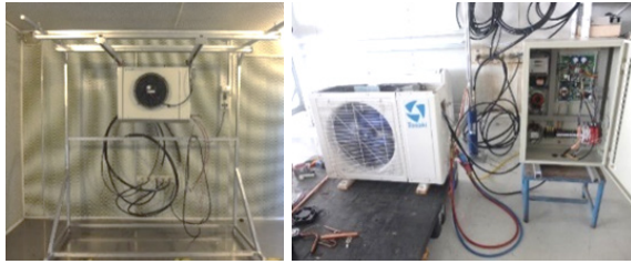
รูปที่ 10 การทดสอบประสิทธิภาพกักเก็บความเย็น
