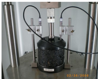
รูปที่ 6 การทดสอบความต้านทานต่อการเปลี่ยนรูปร่าง
